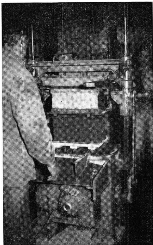
Stroj za izdelavo žilindrine opeke
