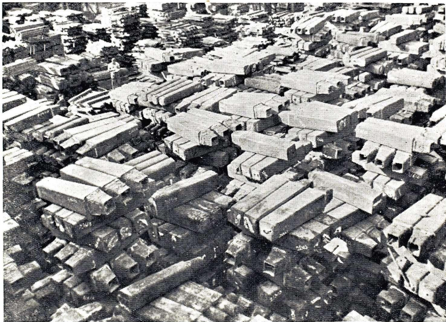
Slika 11 (k članku na str. 152). Zdaj se ingoti še kopičijo, ker stari javorniški obrati miso kos povečani proizvodnji jeklarne. Z dokončno zgraditvijo modernih valjarn pa tudi tega problema ne bo več.
